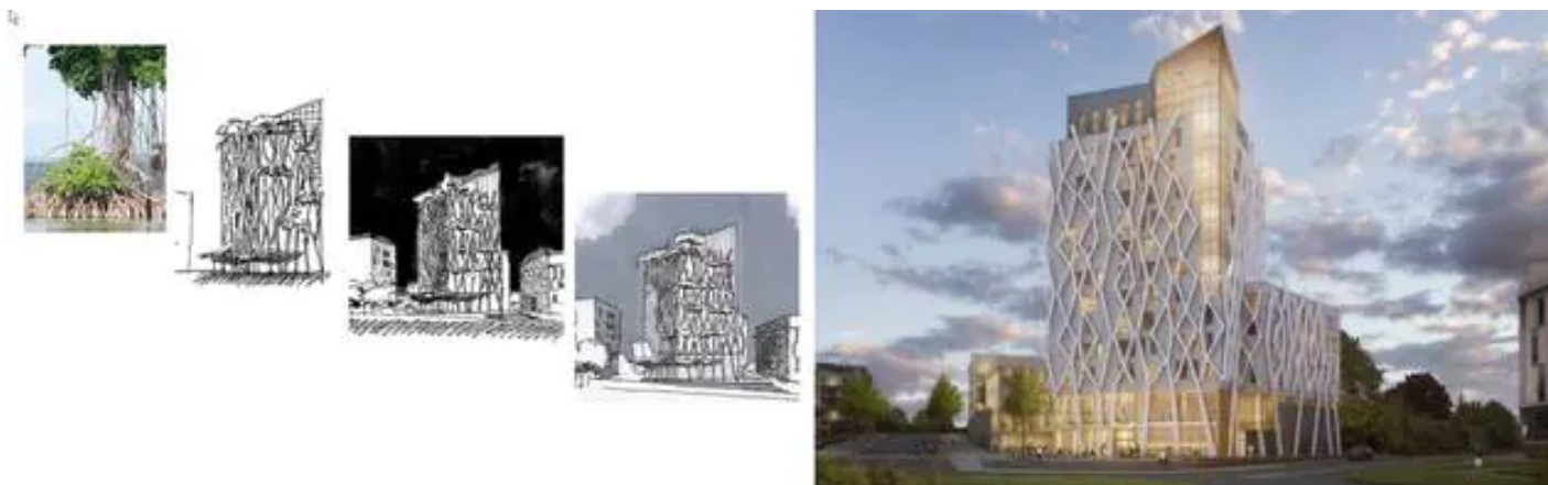
L'inspiration de l'architecte Frédéric Rolland qui a abouti à cette résille en béton blanc. | ROLLAND & ASSOCIÉS
